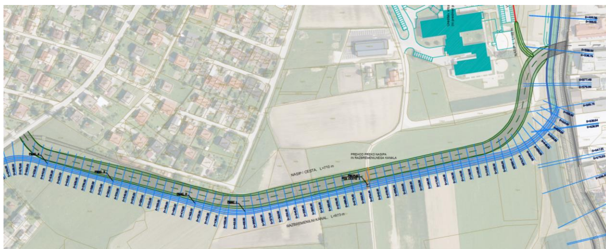
Slika 9: Predviden nasip (cesta) ob razbremenilnem kanalu.
